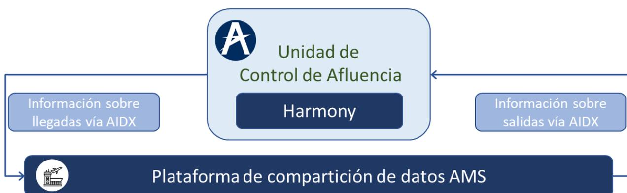
**Figura 30. Modelo conceptual de integración ATFM / A-CDM**
