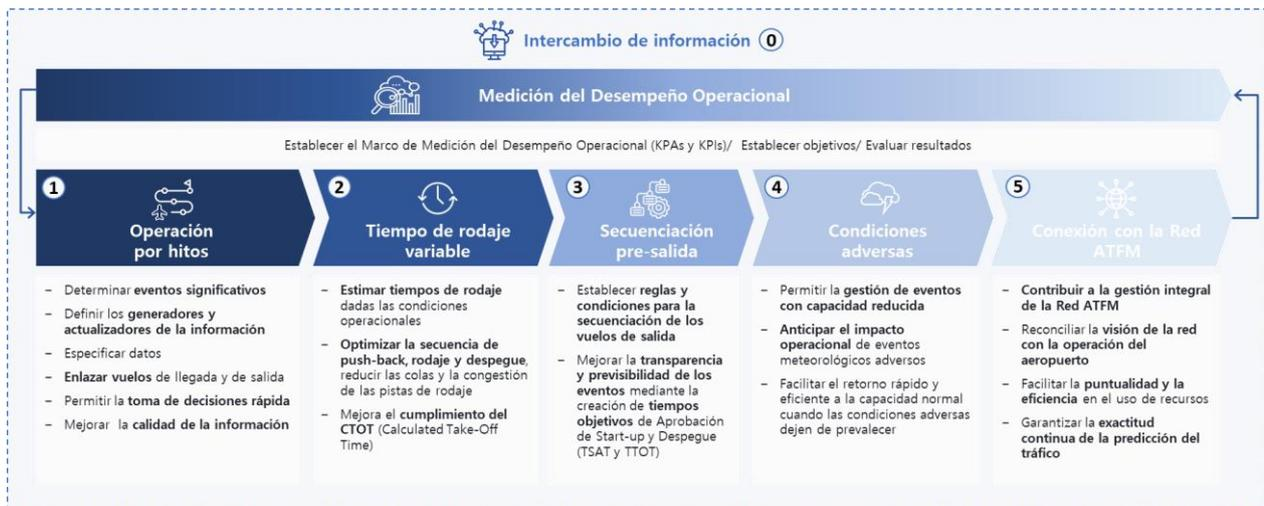
**Figura 3. Elementos conceptuales del A-CDM**
